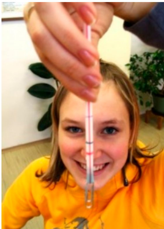
Obr. 2 Usazení kýlu hustoměru (Foto: J. Soukupová)
